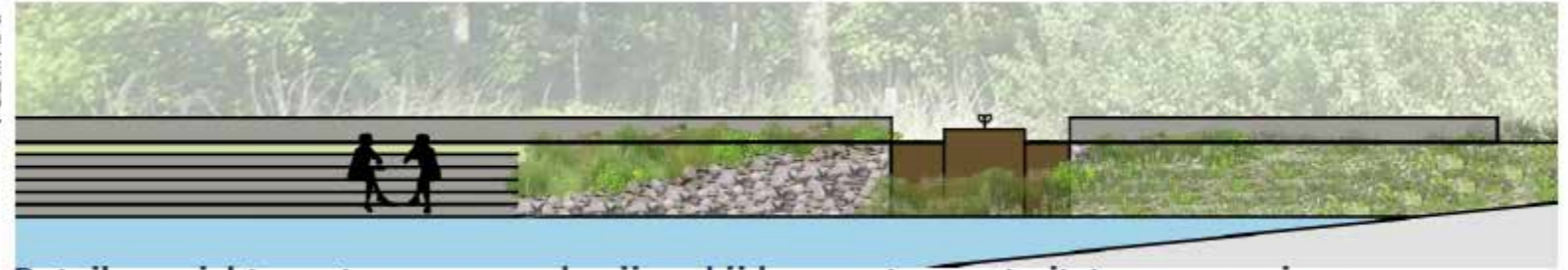
Detail aanzicht van trappen van de vijver bij laag water met uitstroom opening
